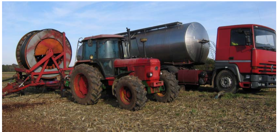
Les effluents sont livrés par camion-citerne et épandus à l'aide d'un canon asperseur.
