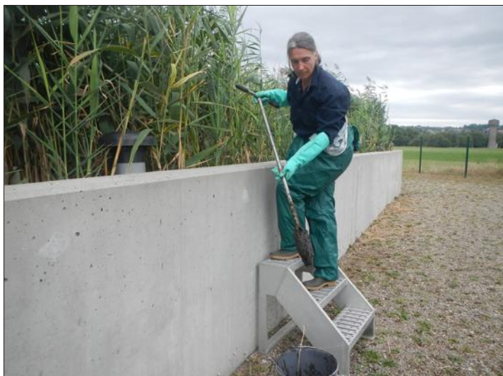
La qualité des boues est analysée régulièrement. Des prélèvements par carottage sont effectués.
