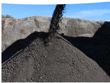
Cendres de chaufferies biomasse
