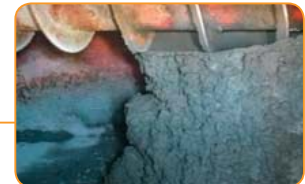
Cendres sous-foyer (bienne avec vis de convoyage)
