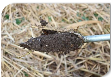
Surveillance de la hauteur de boues dans les lits plantés de roseaux lors des visites conjointes SATESE/SMRA68
