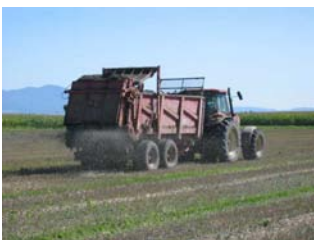
Le minimum pour les boues déshydratées : un épandeur avec table de répartition.
