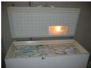
Echantillons de contrôle : prélever tous les camions, stocker les échantillons et effectuer des analyses aléatoires.
