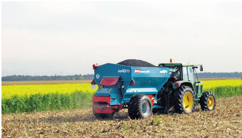
Épandage de boues séchées à Ensisheim à l'aide d'un épandeur à engrais modifié.
